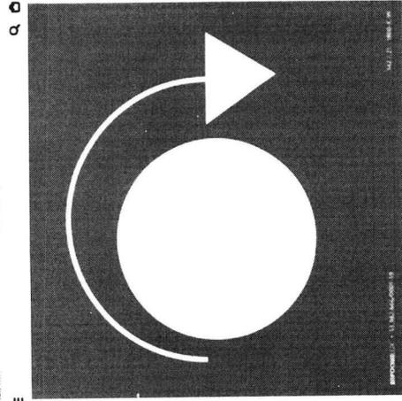
S22 - Mecanismo de Abertura da Porta de Saída de Emergência - Fotoluminescente
