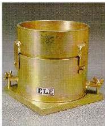
Figura 25: Molde do ensaio proctor
